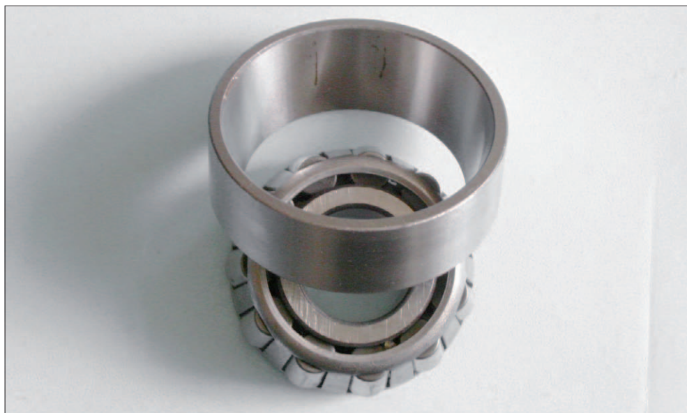
Fot. 4.1. Badanie właściwości przeciwkorozyjnych smarów łożyskowych wg ASTM D1743:2013. Ocena stopnia skorodowania łożysk 3-3-2
