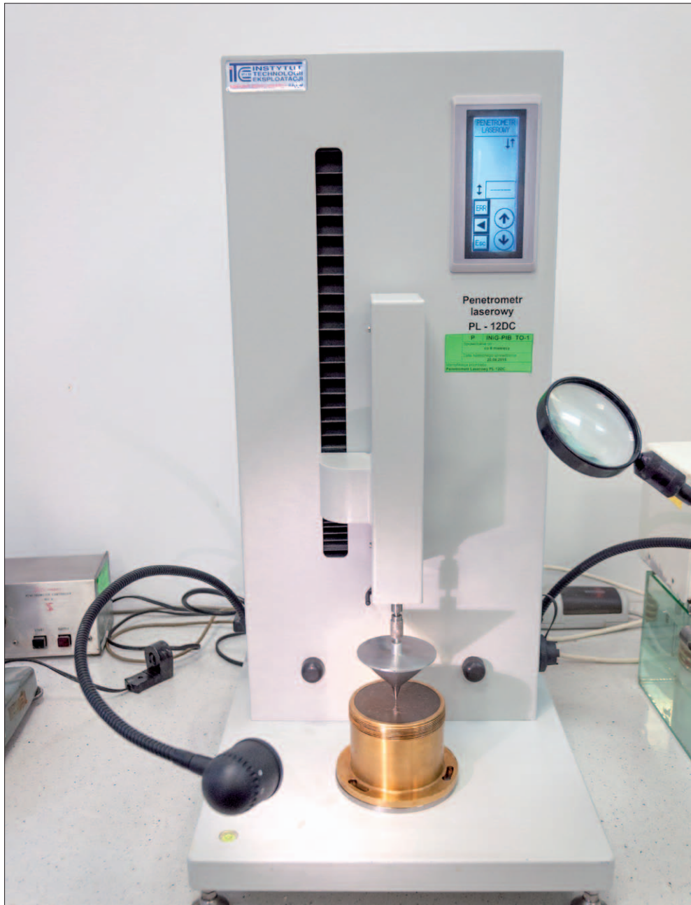
Fot. 1.2. Aparat do oznaczania penetracji smarów plastycznych według PN-ISO 2137:2011
