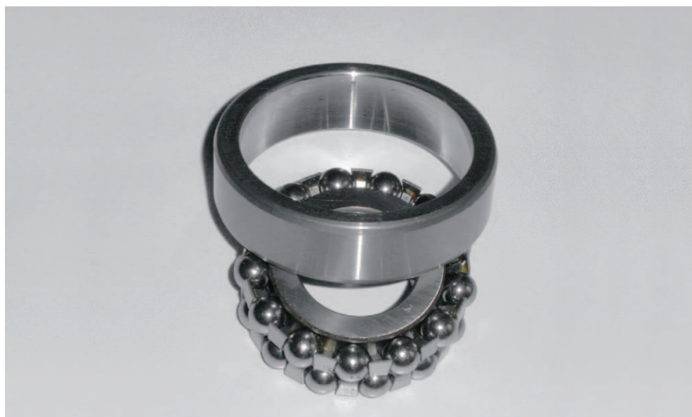
Fot. 4.2. Badanie właściwości przeciwkorozyjnych smarów łożyskowych wg PN-ISO 11007:2010. Ocena stopnia skorodowania łożysk 2-2-1
