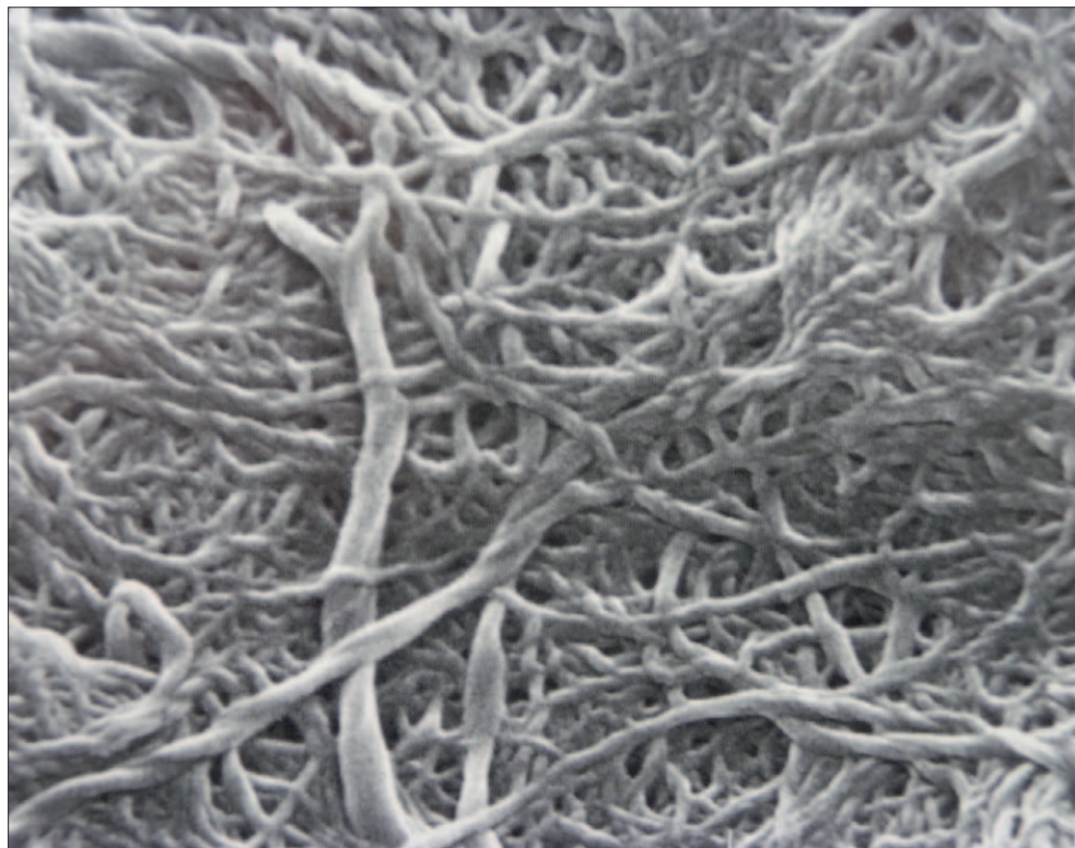
Fot. 1.1. Struktura smaru litowego hydroksystearynowego (mikroskop elektronowy, powiększenie 20 000×)
