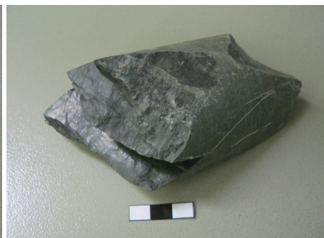
D) iłowiec, otwór Stawiska-1, gł. 3254.30 m
