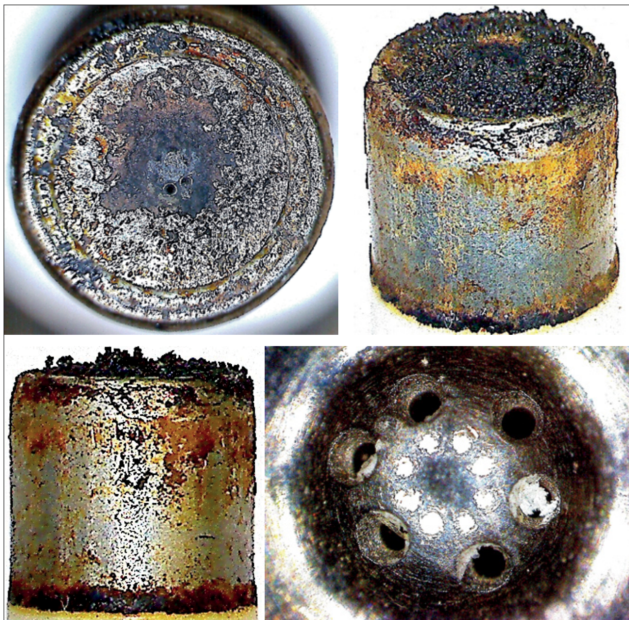
Rysunek 1. Widok osadów na końcówce wtryskiwacza silnika DISI
