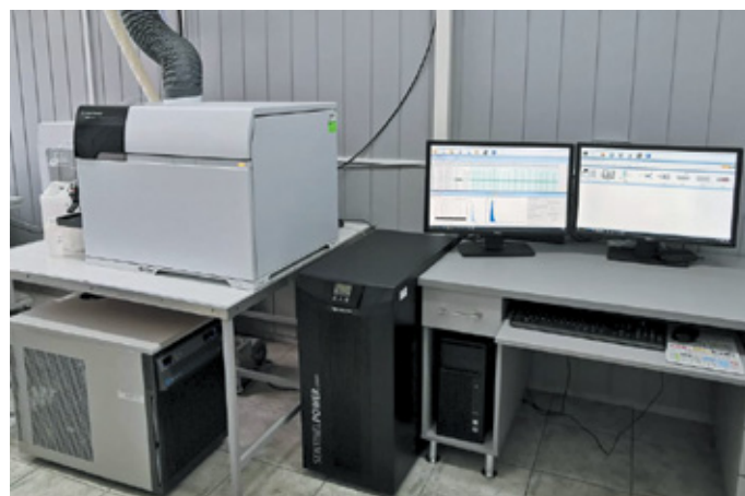
Rys. 1. Spektrometr masowy z plazmą sprzężoną indukcyjnie znajdujący się w Zakładzie Ochrony Środowiska INiG – PIB (fot. P. Wróbel)
