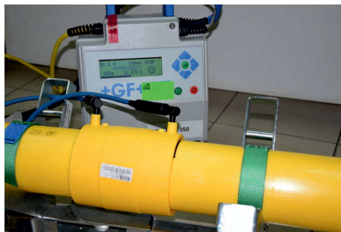
Rys. 3. Proces zgrzewania elektrooporowego kształtki i rur z PA 12 Fig. 3. The process of electrofusion welding of PA12 fitting and pipes
