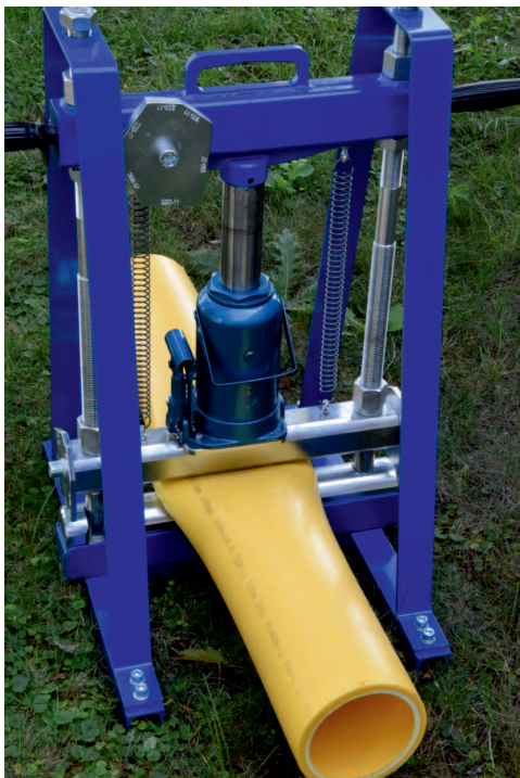
Rys. 2. Zaciśnięta rura z PA 12 Fig. 2. Squeeze-off PA12 pipe
